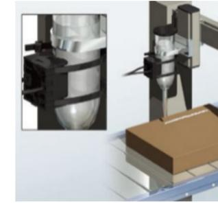
液位传感器检测液体高度
