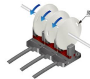
槽型光电的原点检测
